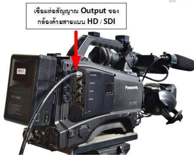
ภาพที่ 4-13 การเชื่อมต่อสัญญาณ Output ของกล้องด้วยสายสัญญาณแบบ HD/SDI
