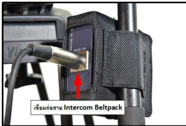
ภาพที่ 4-23 การเชื่อมต่อสัญญาณ Intercom และ Tally Light เข้ากับ Intercom Beltpack
