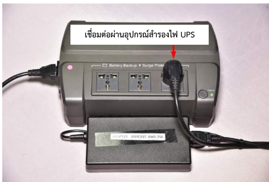
ภาพที่ 4-12 การเชื่อมต่อ AC adapter กับอุปกรณ์สำรองไฟ (UPS)
