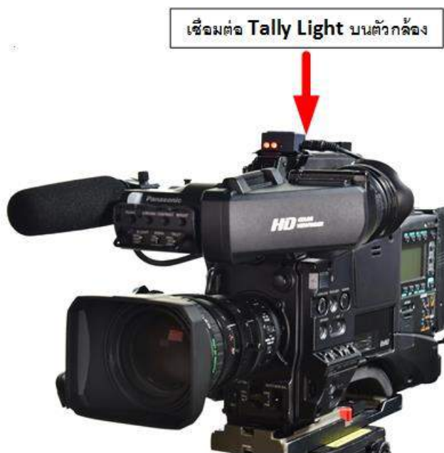
ภาพที่ 4-25 การเชื่อมต่อสาย Tally Light ที่ติดบนตัวกล้อง
