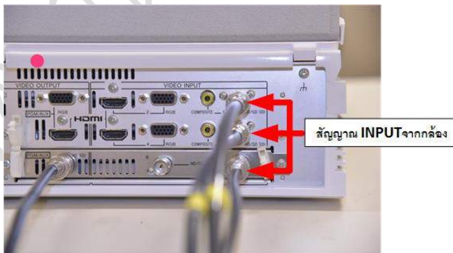
ภาพที่ 4-14 การเชื่อมต่อสัญญาณภาพจากกล้องเข้ากับ Input ของเครื่องสลับภาพ
