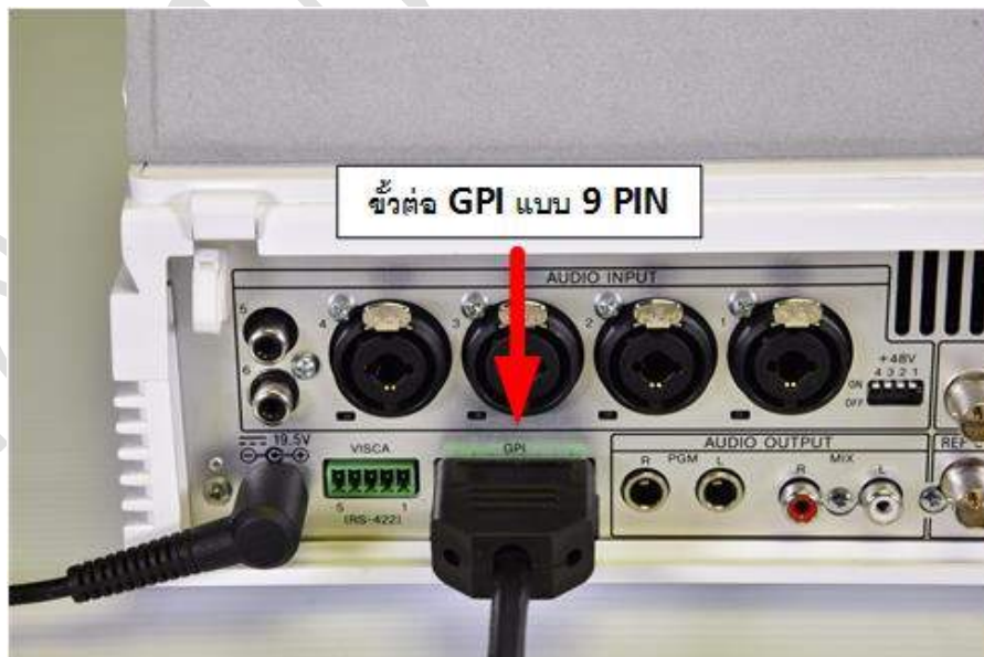
ภาพที่ 4-20 การเชื่อมต่อสัญญาณ Tally เข้ากับเครื่องสลับภาพด้วยขั้วต่อแบบ GPI
