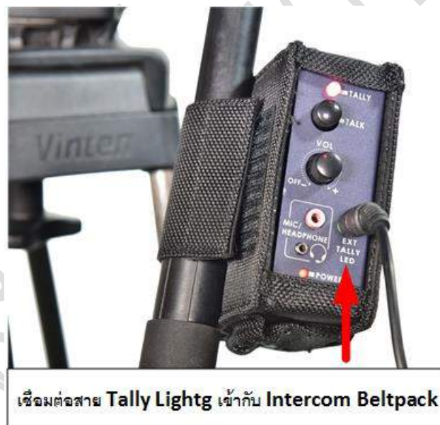
ภาพที่ 4-24 การเชื่อมต่อสาย Tally Light ของกล้องกับ Intercom Beltpack
