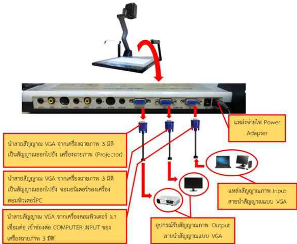
ภาพที่ 4.22 ขั้นตอนการติดตั้งเครื่องฉายภาพ 3 มิติ (Digital Visualizer)
