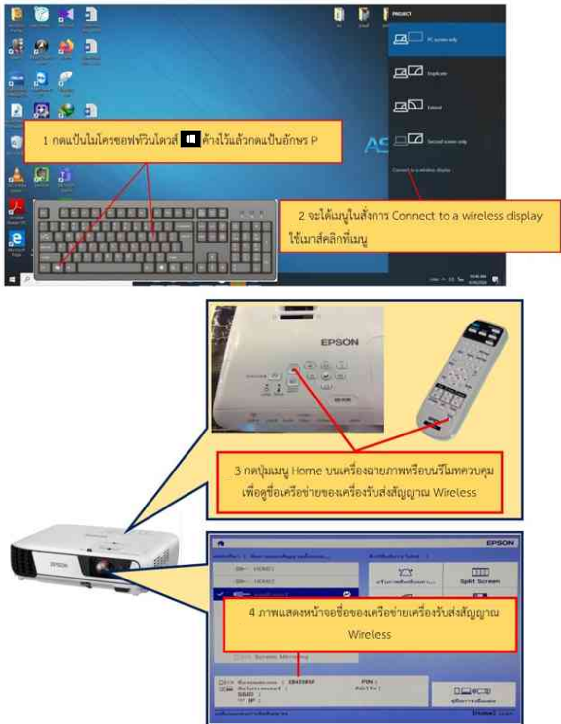
ภาพที่ 4.39 ขั้นตอนการทดสอบและควบคุมระบบภาพเครื่องฉายภาพ (Projector)การใช้งานในแบบ Wireless (ต่อ)
