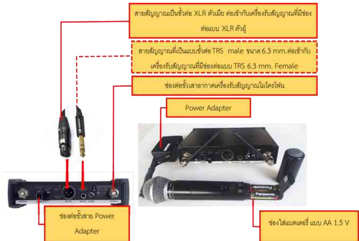
ภาพที่ 4.16 ขั้นตอนการติดตั้งไมโครโฟนแบบไร้สาย (Wireless Microphone)
