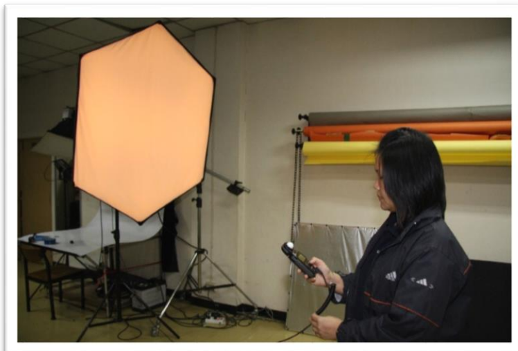
ภาพที่ 4.4 ลักษณะการใช้งานของเครื่องวัดแสง
