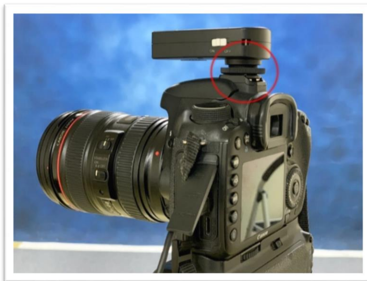
ภาพที่ 4.6 ลักษณะการประกอบ Wireless Flash Trigger เข้ากับตัวกล้อง
