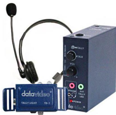
ภาพที่ 3-7 ระบบสื่อสาร (Intercom) ตัวลูก (Belt Pack) และ Tally Light
