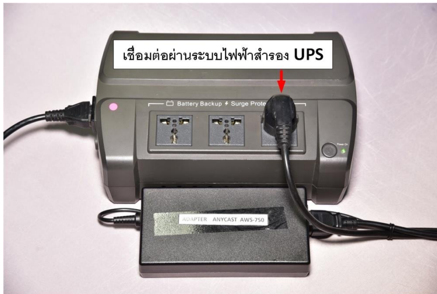
ภาพที่ 4-12 การเชื่อมต่อ AC adapter กับระบบไฟสำรอง(UPS)
