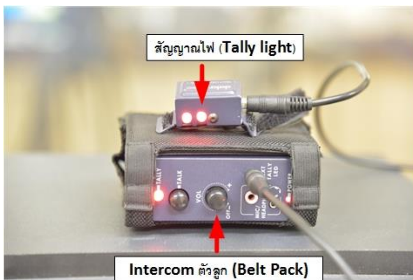
ภาพที่ 4-47 การทดสอบสัญญาณไฟ Tally
