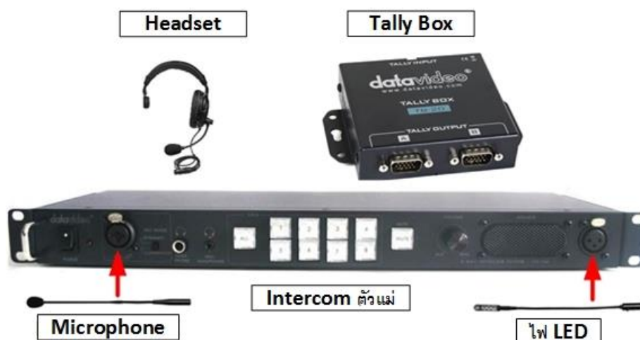
ภาพที่ 3-6 ระบบสื่อสาร(Intercom) ตัวแม่ และ Tally Box
