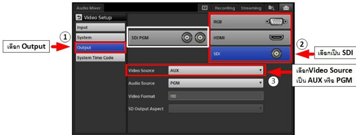
ภาพที่ 4-36 การเลือกสัญญาณ Output ของ Video แบบ HD (1080i)
