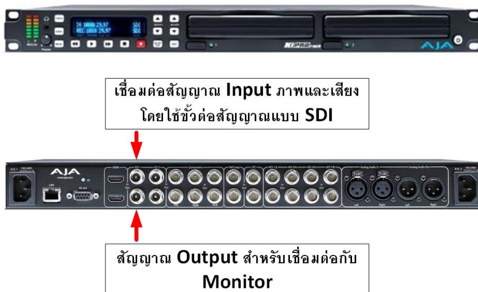
ภาพที่ 4-16 การเชื่อมต่อสัญญาณเข้ากับเครื่องบันทึกไฟล์วิดีโอภายนอกที่ขั้วต่อสัญญาณแบบ SDI In
