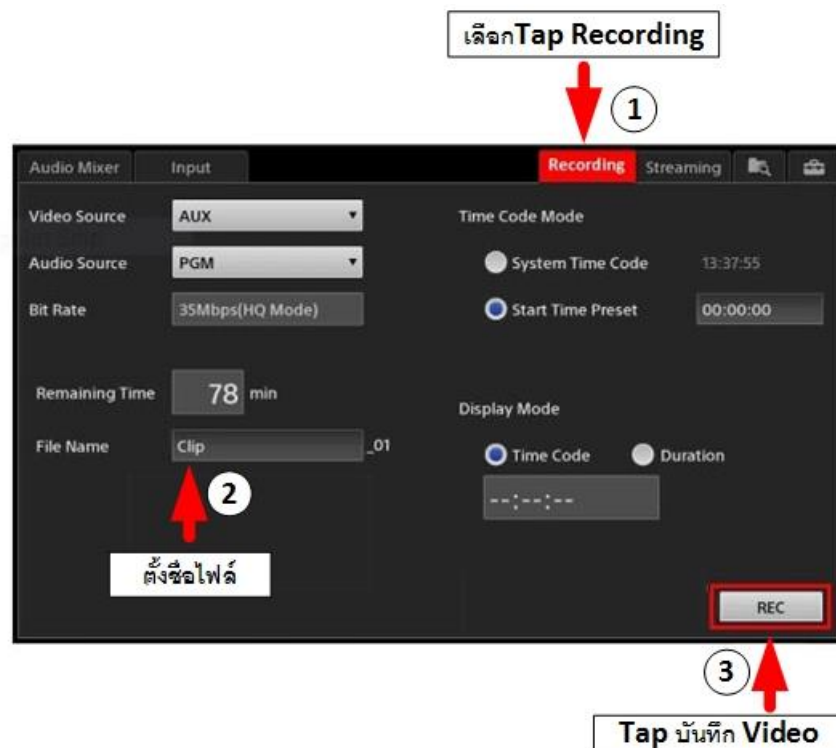
ภาพที่ 4-49 การทดสอบระบบการทำงานของอุปกรณ์ทั้งหมดโดยการบันทึกไฟล์ Video
