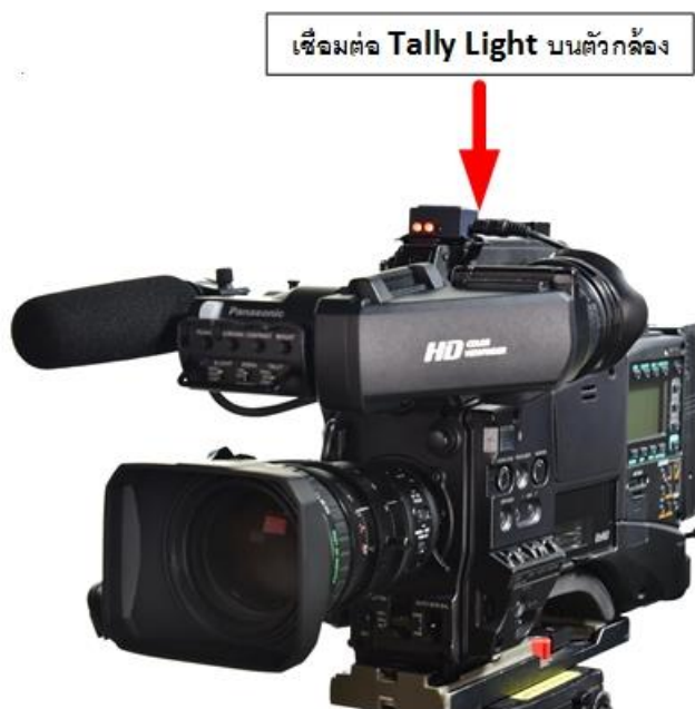
ภาพที่ 4-25 การเชื่อมต่อสาย Tally Light ที่ติดบนตัวกล้อง ที่มา : เซวรัตน์ แจ่มหล้า
