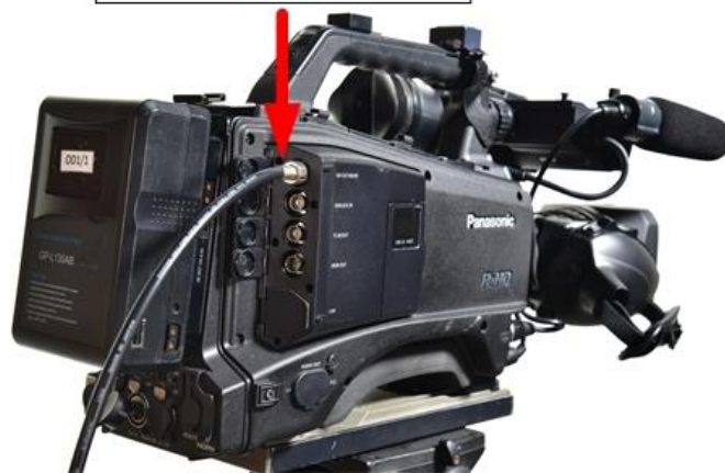
ภาพที่ 4-13 การเชื่อมต่อสัญญาณ Output ของกล้องด้วยสายสัญญาณแบบ HD/SDI
