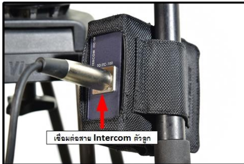
ภาพที่ 4-23 การเชื่อมต่อสัญญาณ Intercom และ Tally Light เข้ากับ Intercom ตัวลูก
