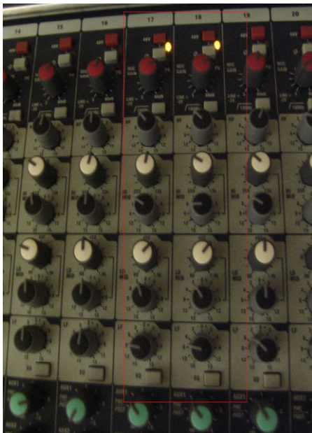
รูปที่ 26 ตัวอย่างการปรับตั้งโทนเสียงบนมิกเซอร์
