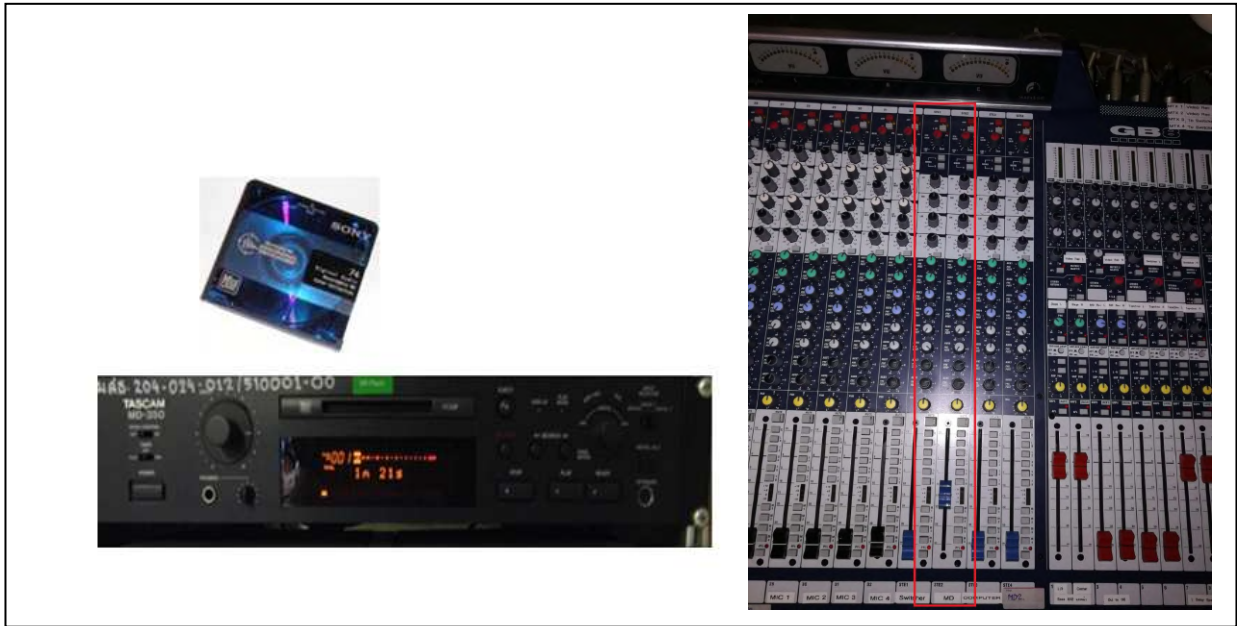
รูปที่ 28 เครื่องเล่น MD และตัวอย่างการเผดเตอร์บนช่องมิกเซอร์ (ที่มา รูปที่ 28 : พิชัย จ้อยรุ่ง)
