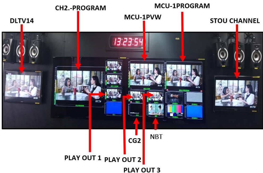
ภาพที่ 4-14 สถานะปกติของจอแสดงผลภาพ (Multiview Monitor)
