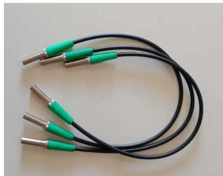
ภาพที่ 3-27 สายต่อพ่วง (Patch cord)
