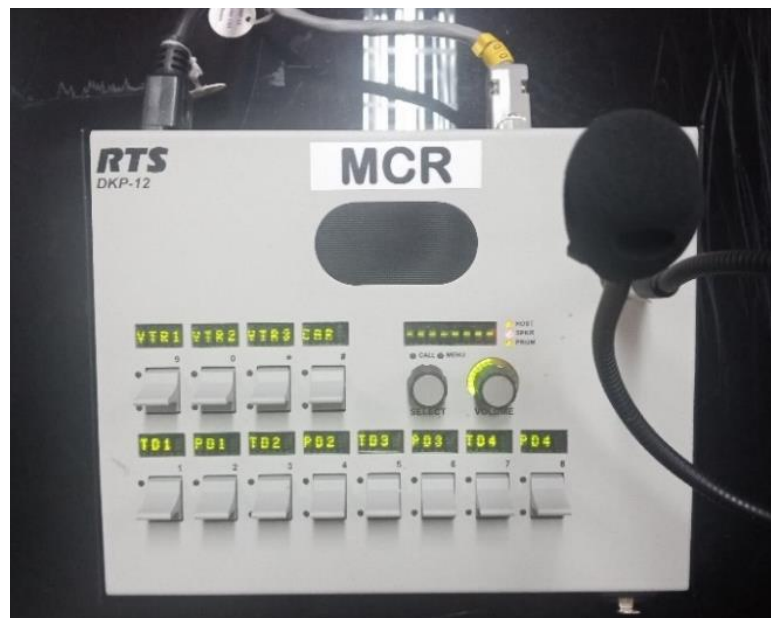
ภาพที่ 3-21 อุปกรณ์สื่อสาร (Intercom)
