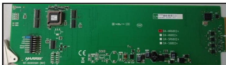
ภาพที่ 5-10 การ์ด DA7 ตัวที่สำรองไว้มาเปลี่ยนกับตัวที่เสีย
