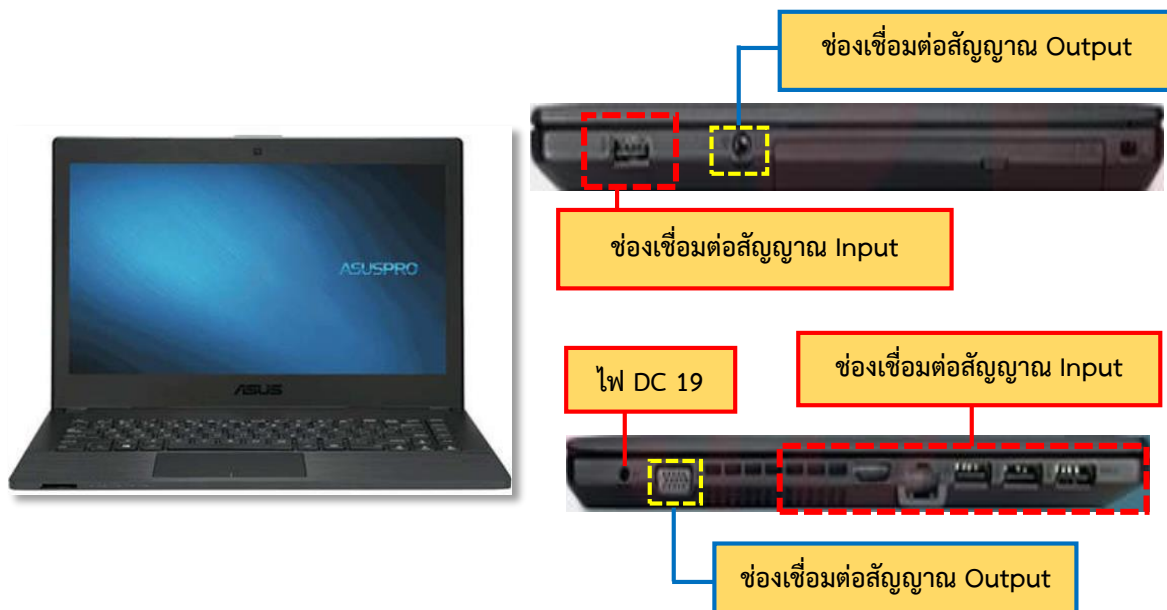
ภาพที่ 3.11 เครื่องคอมพิวเตอร์ขนาดเล็ก หรือ (Notebook Computer)
