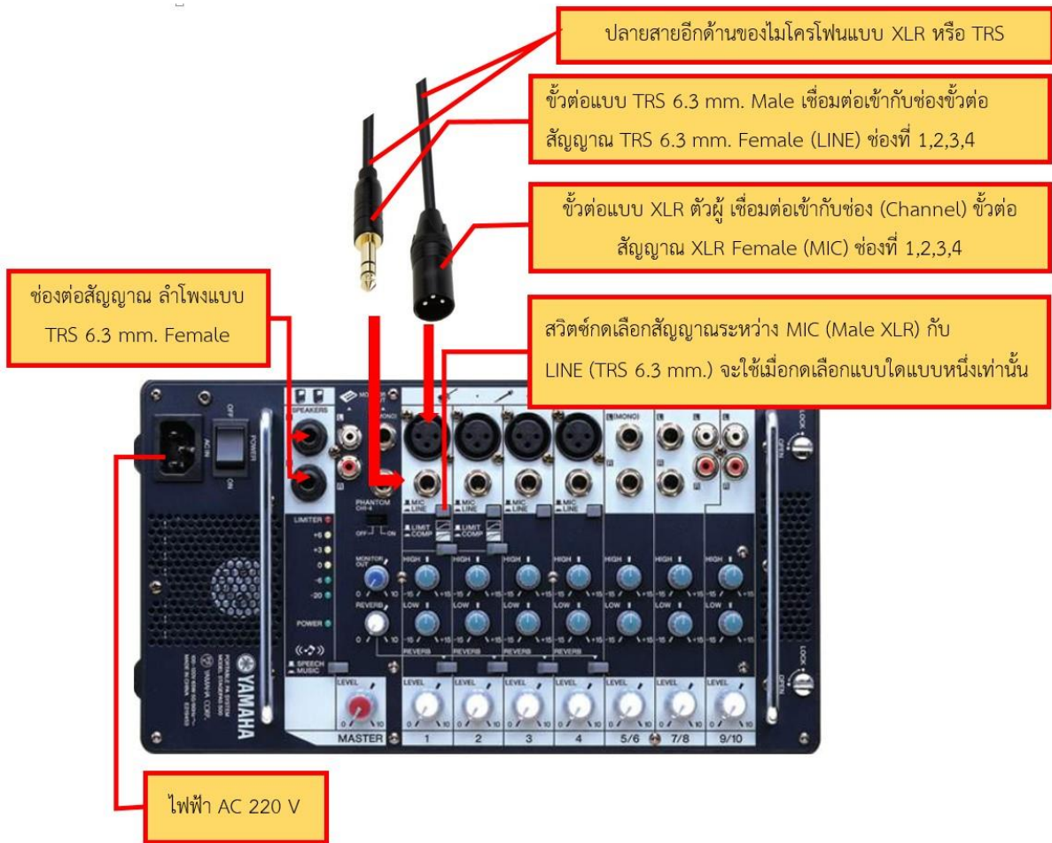
ภาพที่ 4.17 ขั้นตอนการติดตั้งเครื่องผสมเสียงแบบมีเครื่องขยายเสียงในตัว (Powered Mixer)
