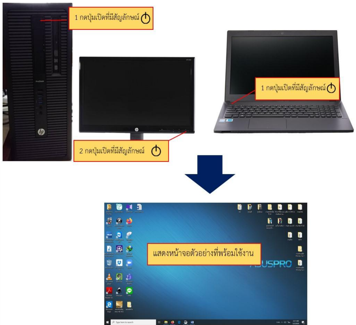
ภาพที่ 4.34 ขั้นตอนการทดสอบและควบคุมระบบภาพเครื่องคอมพิวเตอร์(Computer) : เครื่อง PC/Notebook
